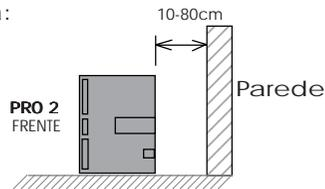
Obs.: O nível máximo de graves devido a sua posição é obtido quando a caixa é colocada no canto (vértice) de duas paredes.
